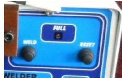
Quando a carga dos capacitores atingirem a potencia ajustada, o LED indicando "FULL" irá acender, indicando que a máquina está pronta para a soldagem.
