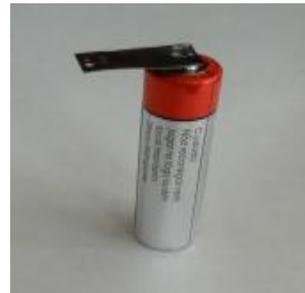
**ATENÇÃO:** É muito importante na soldagem por descarga capacitiva, que a pressão entre os eletrodos esteja correta, assim como é fundamental que exista um perfeito ajuste entre as peças a serem soldadas para evitar faiscamento. Neste tipo de solda, quando a pressão entre os eletrodos e peça, assim como a intensidade de potência estiver correta, não existe faiscamento, produzindo uma solda limpa, sem aquecimento.
