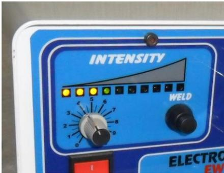
O botão "WELD" é utilizado para disparar a solda. Quando a carga dos capacitores atingirem a potencia ajustada, o LED indicando "FULL" irá acender, indicando que a máquina está pronta para a soldagem.
